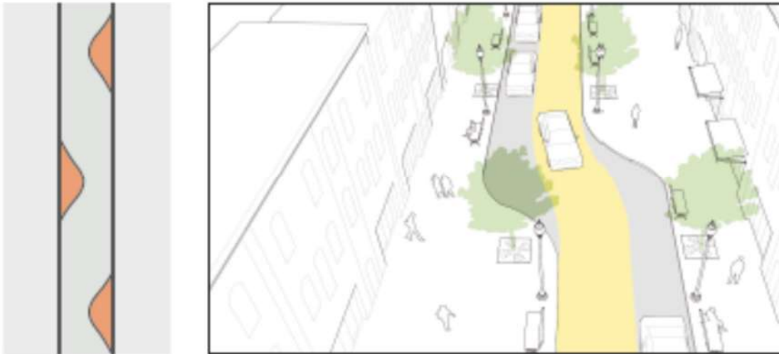
Figura 37 Exemplo do desenho urbano das Chicanas. Fonte: Nacto
