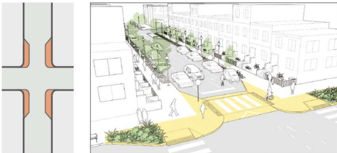
Figura 34 Esquema de intervenções nas portas da zona 30. Fonte: Nacto.
