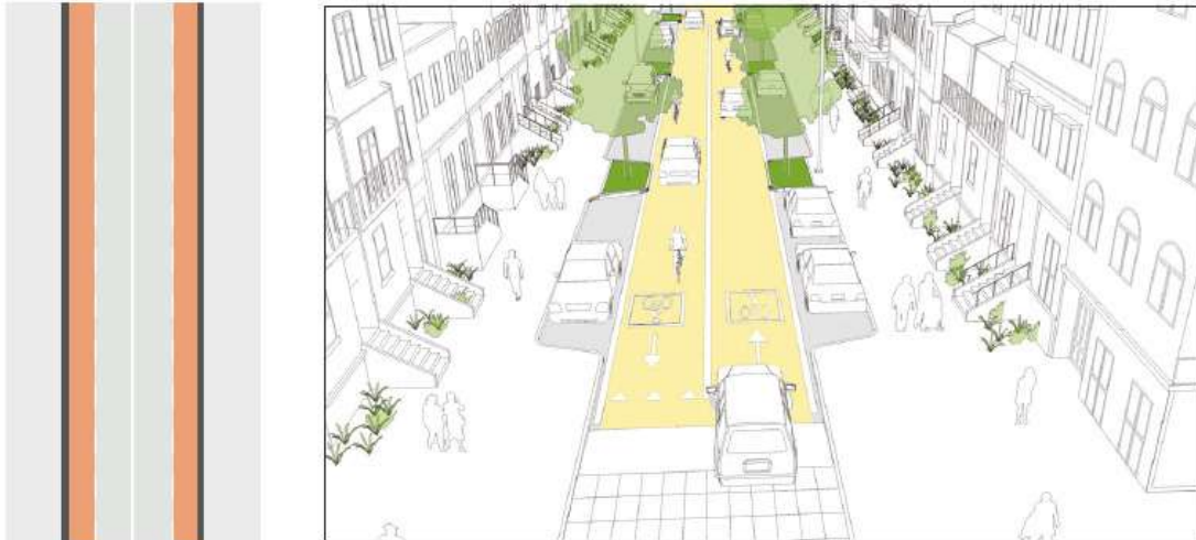
Figura 35 O estreitamento da via reduz a velocidade e proporciona mais espaço para pedestres. Fonte: Nacto.
