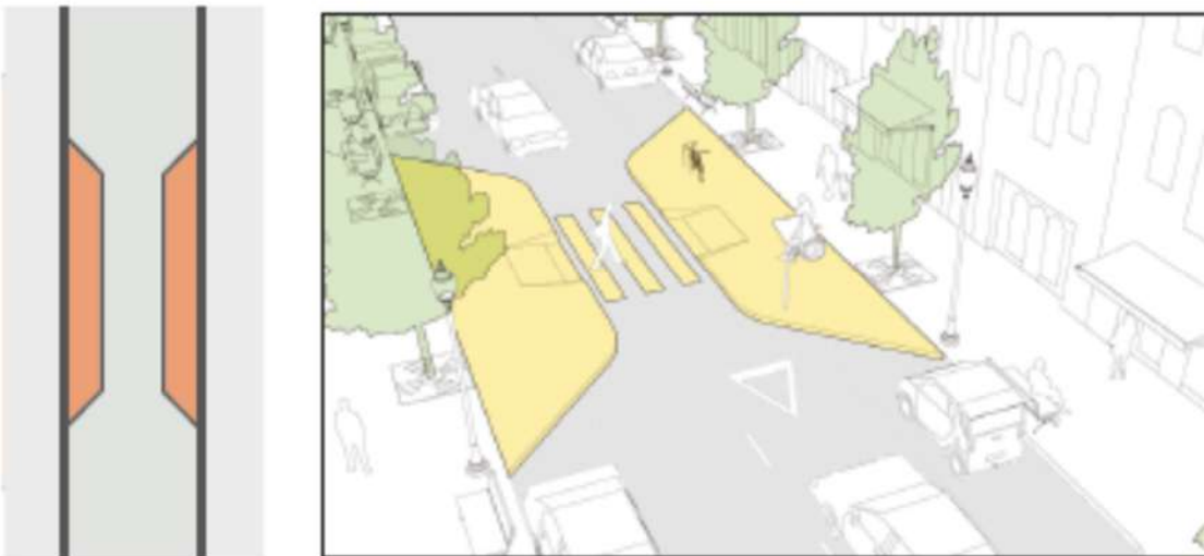
Figura 38 Exemplo de desenho urbano de estrangulamento da via. Fonte: Nacto.
