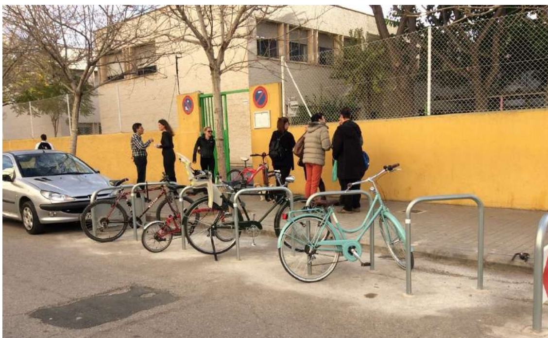
Imagem 29 Estacionamento de bicicletas do tipo U invertido ocupando uma vaga de carro na porta de uma escola. Valencia
