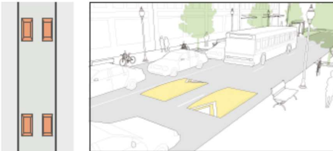
Figura 42 Exemplo de lombadas descontinuas. Fonte: Nacto.
