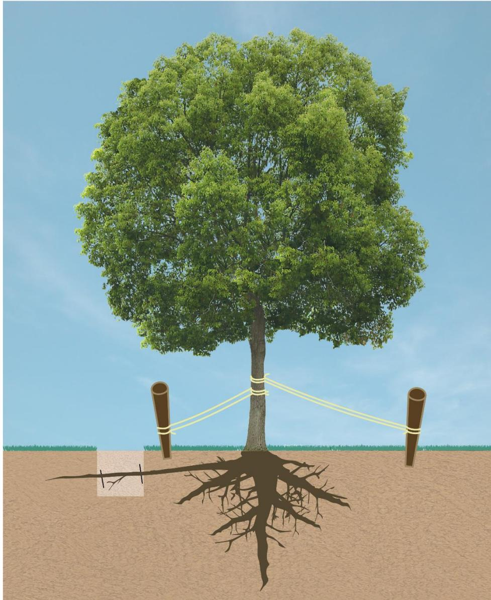
Figura 8 - Escoramento para evitar queda de árvore ao podar a raiz. Fonte: Architectus.
