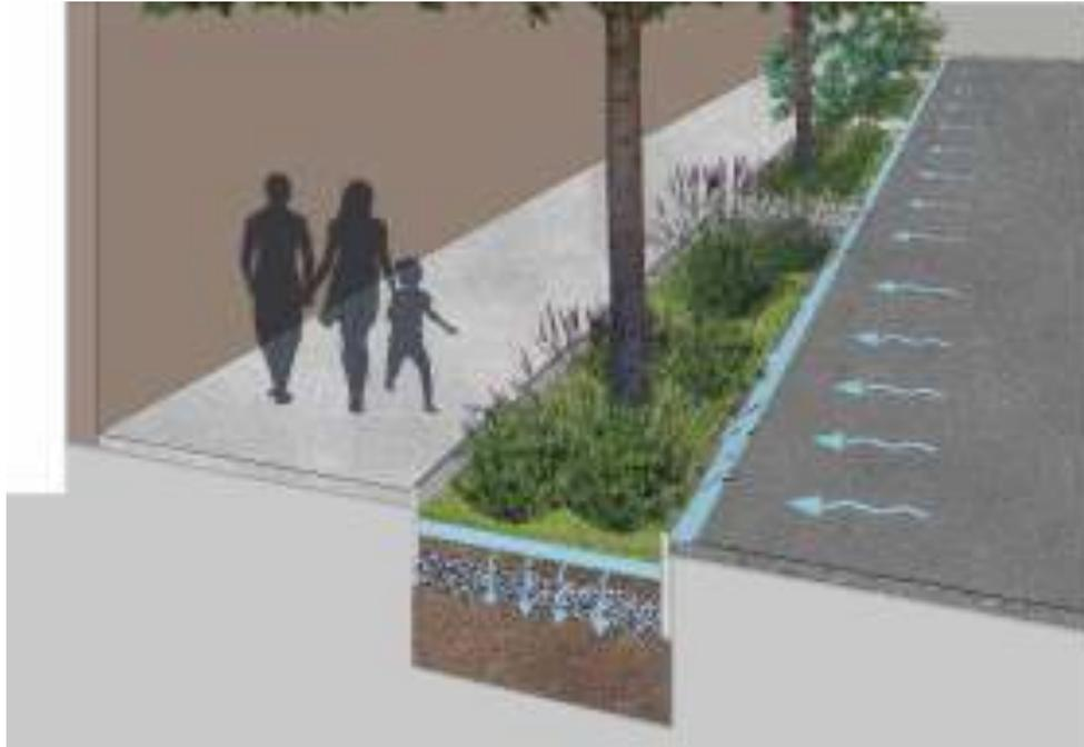
**Figura 69: Canteiro pluvial associado a calçada promove a retenção das águas pluviais e potencializa . Fonte: Architectus**
