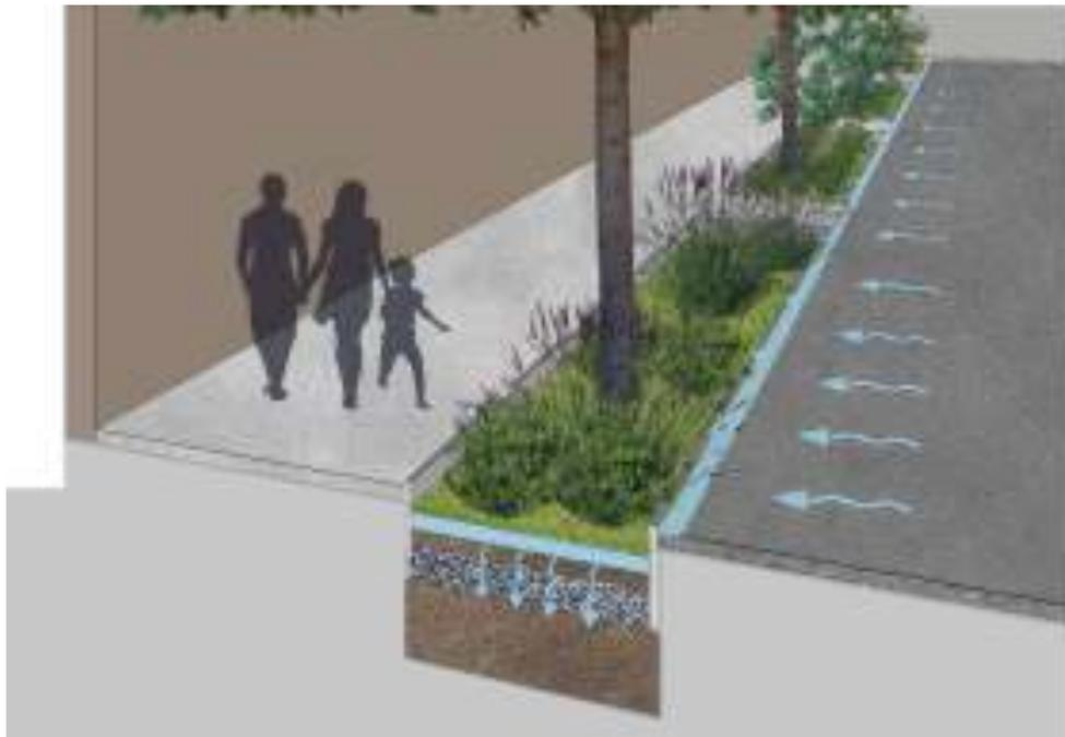
Figura 42: Canteiro pluvial associado a calçada promove a retenção das águas pluviais e potencializa . Fonte: Architectus
